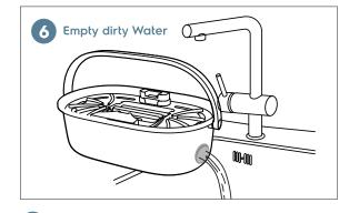
6 Empty the dirty water tank through the drainage hole 汚水を捨てる 배수구를 통해 물통을 비워냅니다. 外槽污水可由側邊排水口排出
